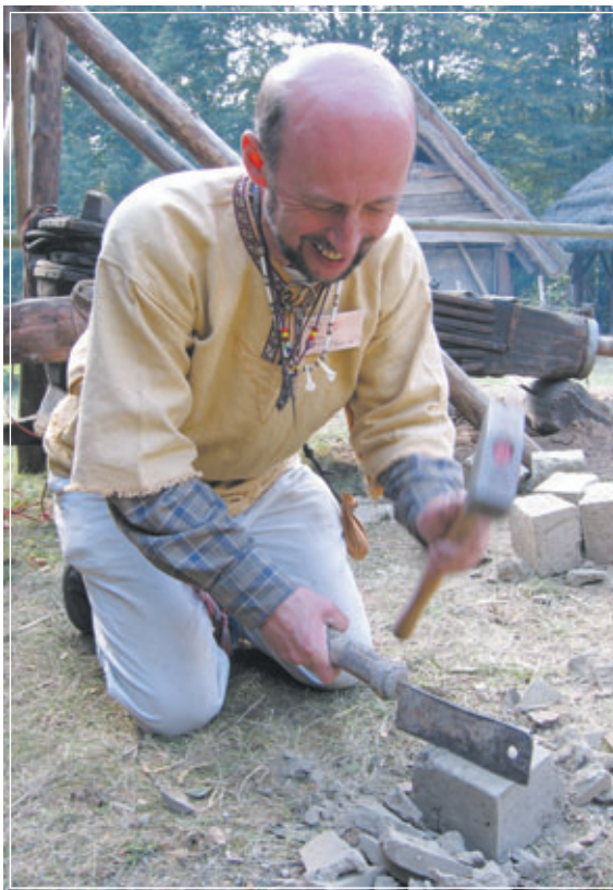
Marek Ziach ciosa cegły, żeby można z nich było zbudować foremną dymarkę. fot. Magdalena Kruszk
